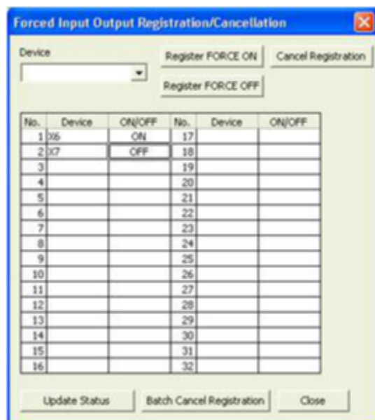
Экран Forced Input Output Registration/Cancellation (Принудительная регистрация/отмена входного/выходного сигнала) (ПЛК серии MELSEC-Q и MELSEC L)
